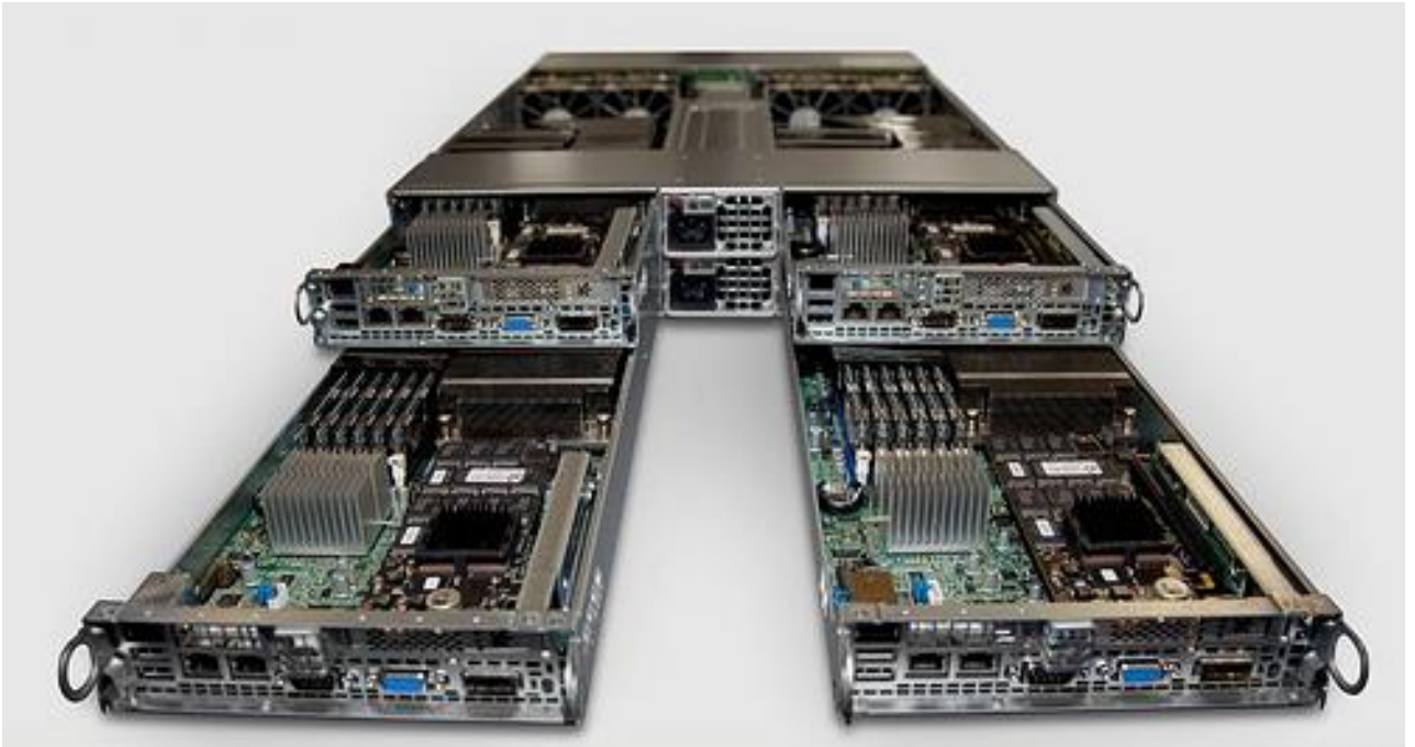
Figura 12: Estructura interna de un servidor Nutanix modelo NX-3060-G
