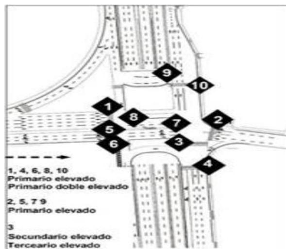
Figura 17. Ubicación y clasificación del sistema de semáforos en la intersección
