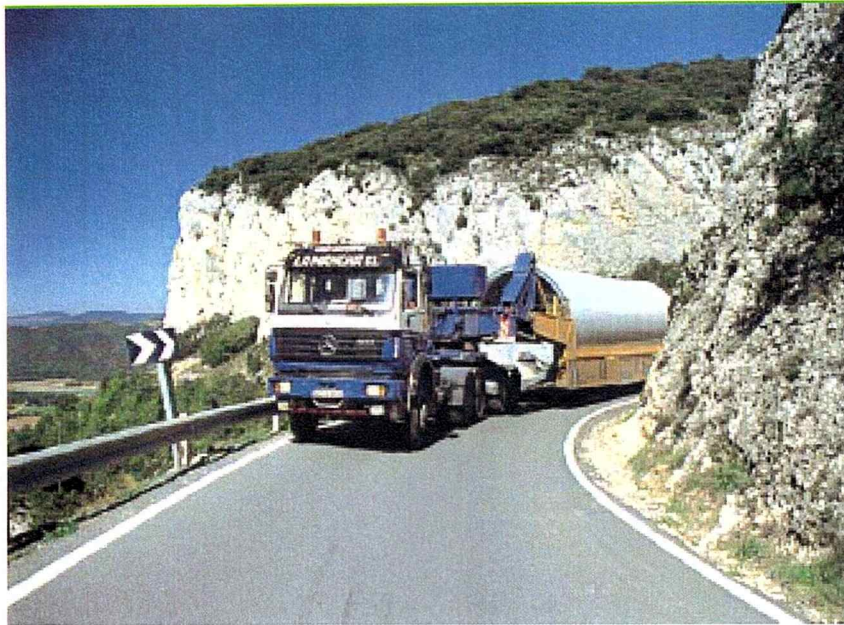
Fig. No. 3.17 transporte de un tramo de la torre
