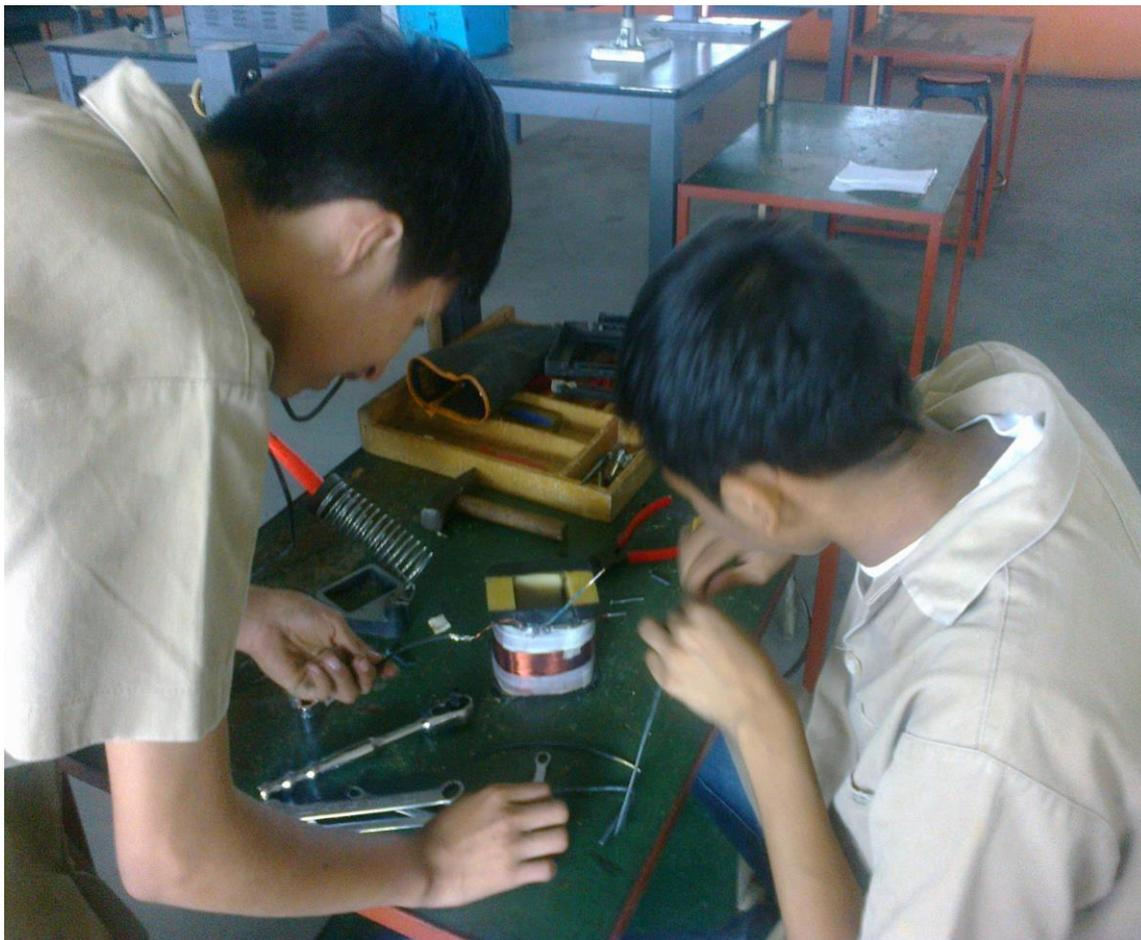
**Foto 2:** Otro equipo de estudiantes, ahora construyendo la bobina de un autotransformador; las características técnicas las han sugerido ellos, su tarea consistirá en DEMOSTRAR la validez de sus cálculos, realizados con los algoritmos matemáticos sugeridos en la práctica.
