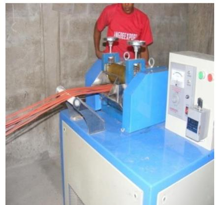
1. El agua refresca a la maquina Peletizadora por que genera mucho calor y el material lo enfría muy rápidamente.
